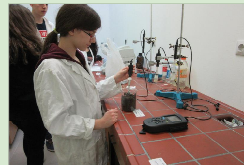
Slika 3. Analiza pH-vrijednosti tla pomoću ubodne sonde
