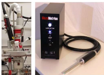
Slika 1. Blaze900 - patentirana tehnologija jednog optičkog puta (eng. Single-Optical-Path Technology)
