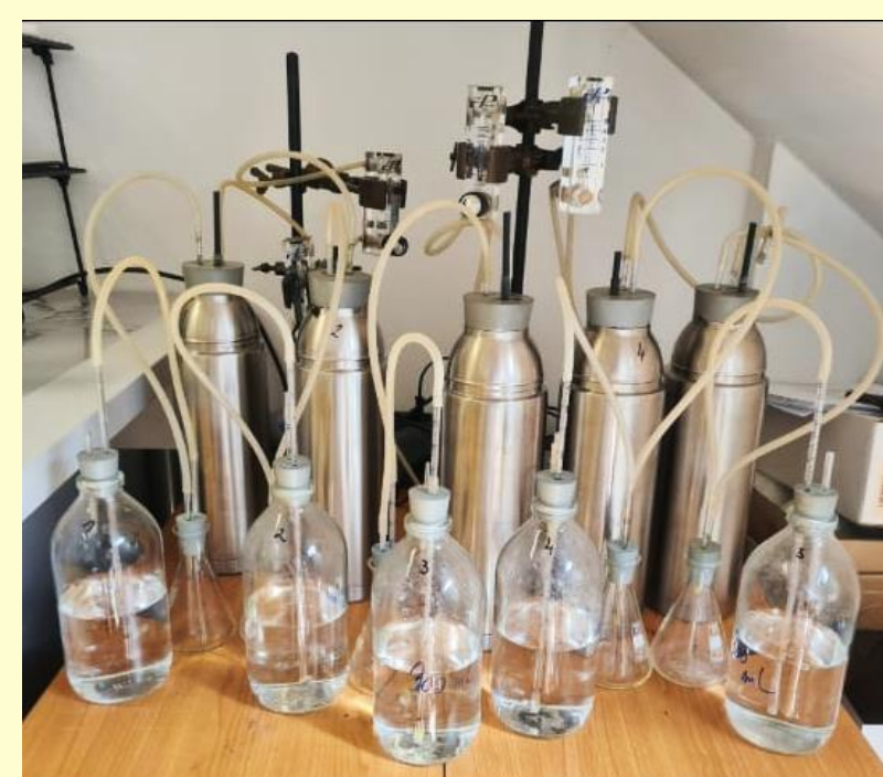
Ispitivanje biorazgradivosti kompozitnih materijala u adijabatskim reaktorima 1 L
